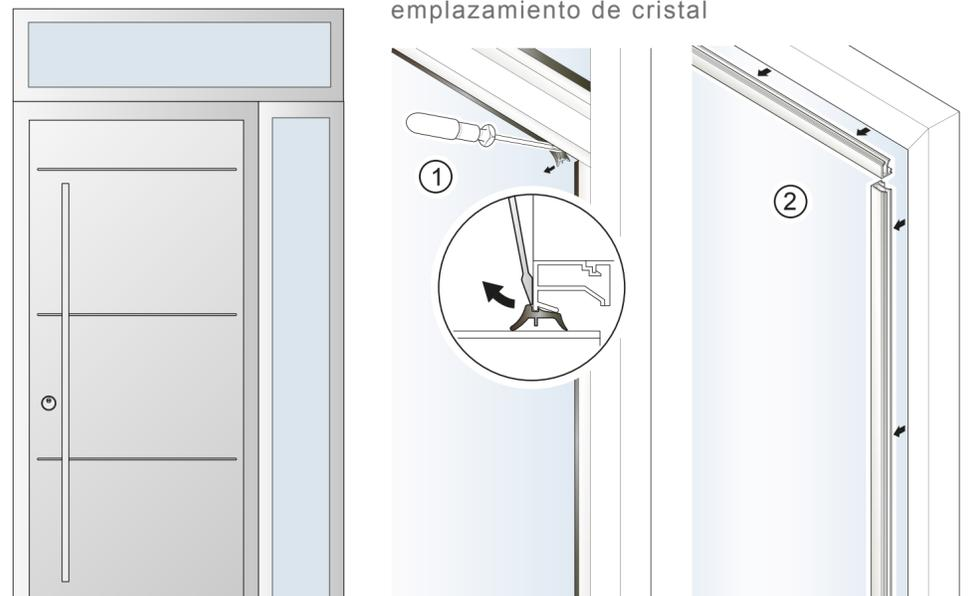
Para estas etapas de desmontaje y montaje de vidrios, use guantes de seguridad.
