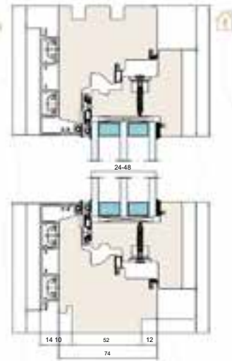
SISTEMA ESPERIA LIFE 74 ALU socavado para alféizares de ventanas interiores y exteriores
